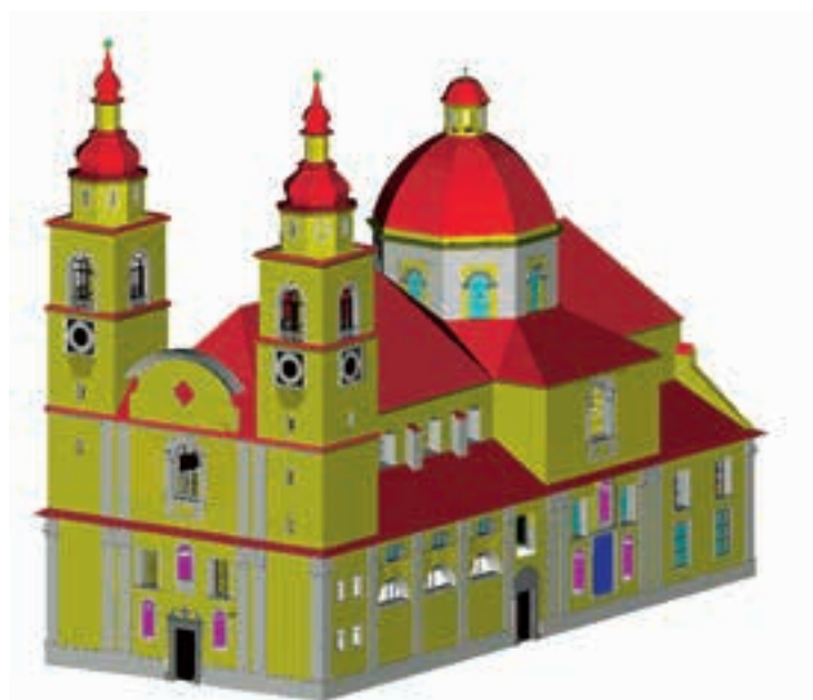
Digitalni metrični ploskovni prostorski model zunanosti stolnice sv. Nikolaja v Ljubljani, 1999 (izdelal Inštitut za geodezijo in fotogrametrijo, Oddelek za fotogrametrijo, arhiv ZVKDS, Restavratorski center)
