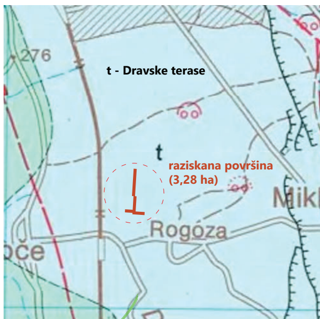
6 Osnovna geološka karta 1 : 50 000, list Maribor in Leibniz (Žnidarčič, Mioč 1989) in površina raziskana z geofizikalno metodo. Raziskana površina se nahaja na eni od dravskih teras (t) s prevladujočo peščeno prodnato sestavo sedimentov in generalno usmeritvijo prodnih sipin vzhod–zahod.
