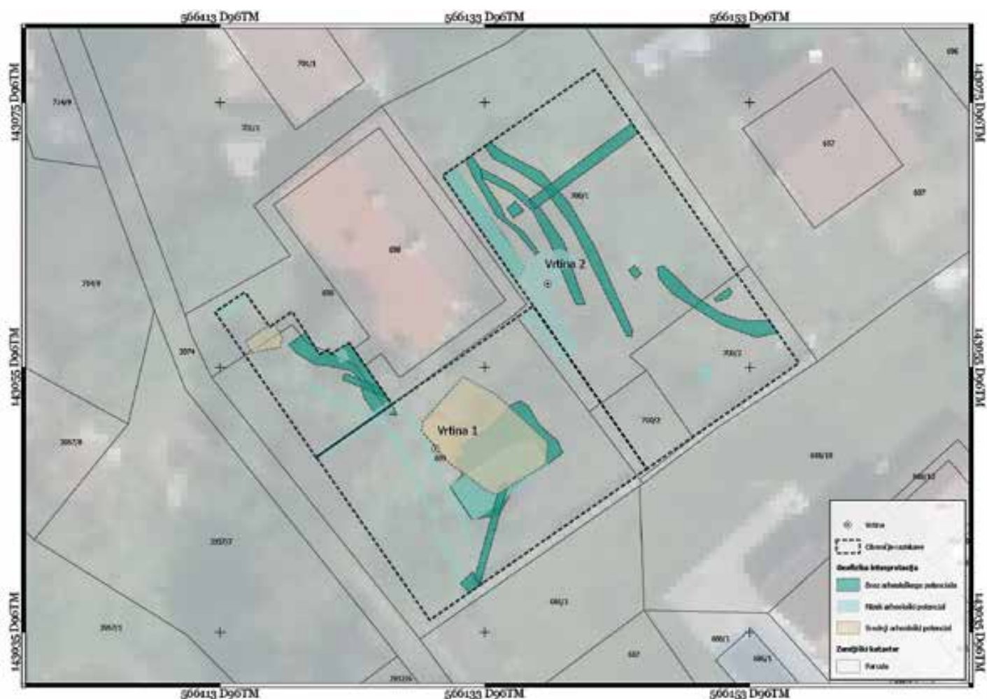
Ptuj, arheološko najdišče Levi breg, arheološka interpretacija georadarske metode in lokacija vrtin (izris: M. Mori)
