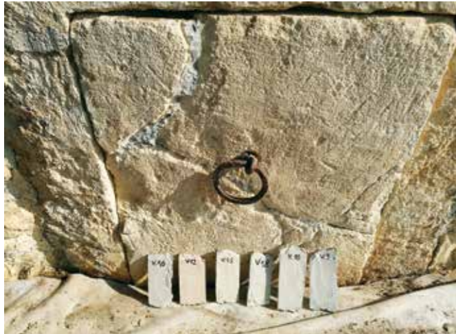
Drnovo, Neviodunum, preizkušanje različnih receptov za pripravo ustrezne nadomestne malte (foto: arhiv ZVKDS, RC)
