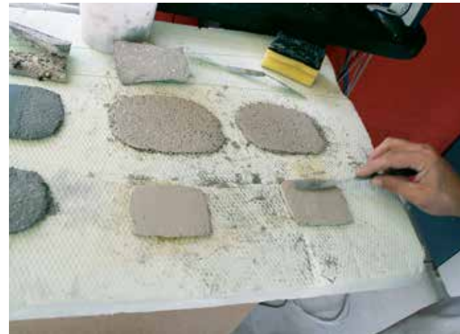
Črna na Koroškem, spomenik žrtvam prve in druge svetovne vojne, preizkušanje različnih nadomestnih malt (foto: arhiv ZVKDS, RC)
