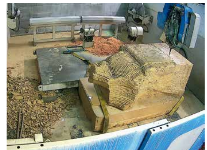
Ljubljana, Vladna palača, rezkanje kopije iz kamnitega bloka na CNC-stroju, (foto: arhiv ZVKDS, Restavratorski center)
