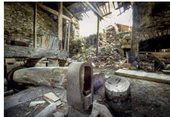
Lokavec, Bavčarjeva fužina, porušena stena s kurišči. V ospredju je kladivo na vodni pogon za oblikovanje bakrene pločevine (foto: K. Karlovini).
