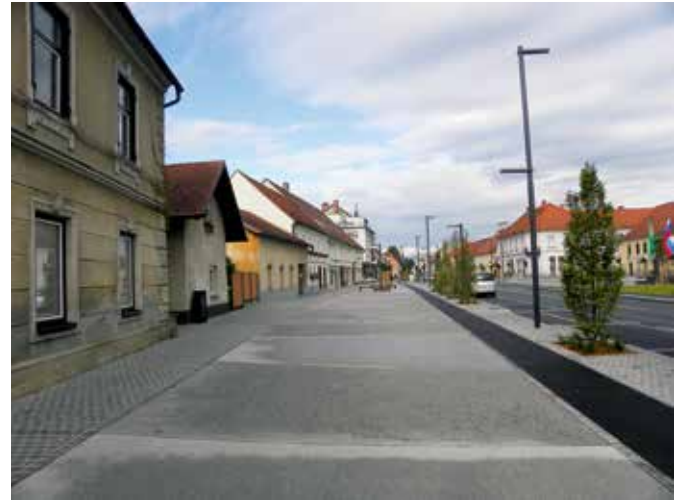
Žalec, Šlandrov trg, zaporedje štokanih in pranih betonskih polj (foto: M. Klemen, 2014)
