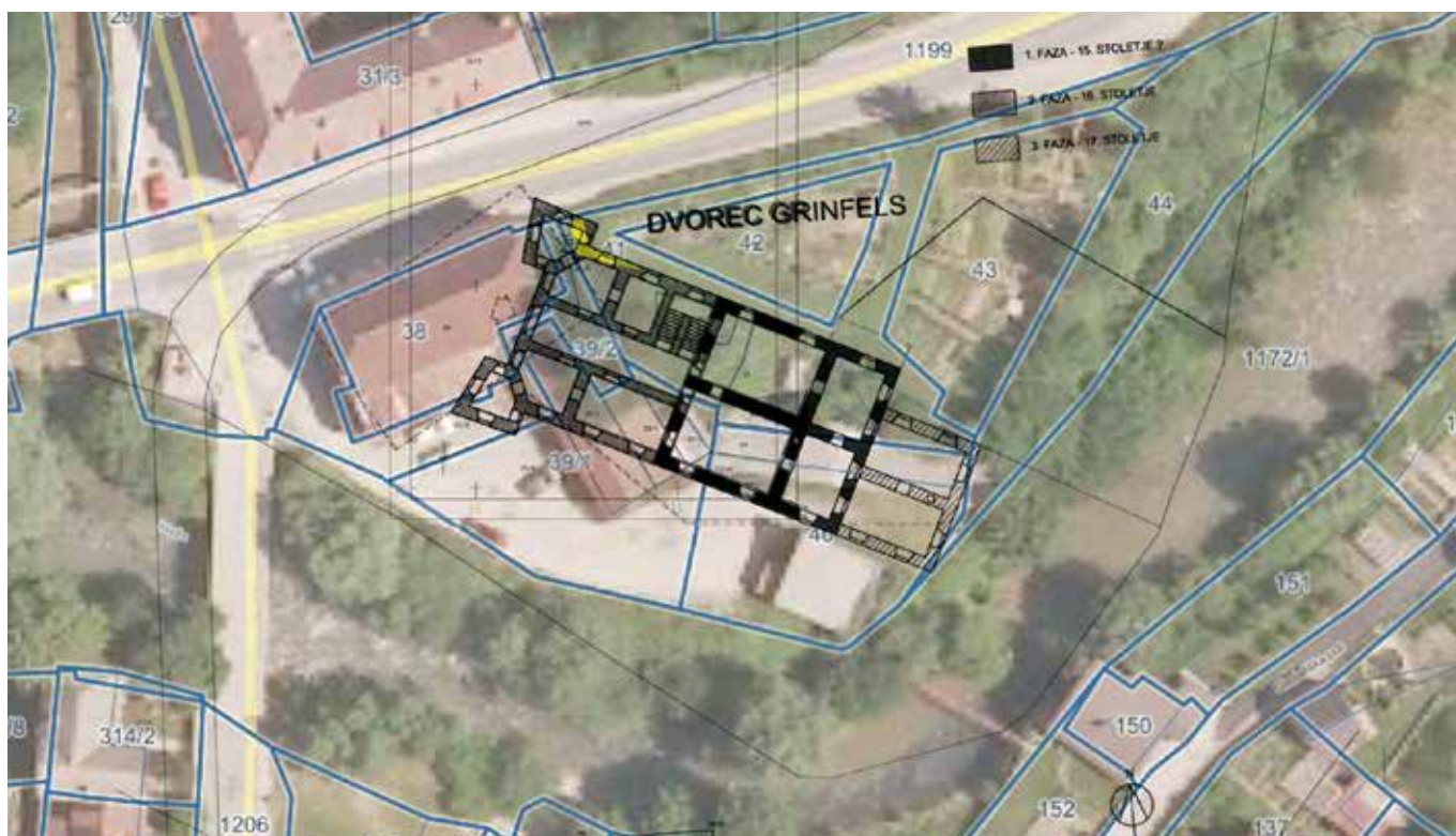
Ravne na Koroškem, ostanki odkritih temeljev (rumeno) in idejna rekonstrukcija tlorisa dvorca Grinfels po dr. I. Sapaču na osnovi Valvasorjeve upodobitve (1688) (vir karte: http://geoprostor.net/piso )
