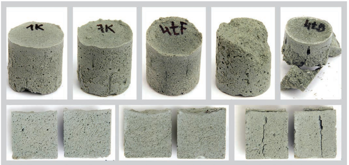
10. Primeri različnih modelirnih mas po polimerizaciji (Zupanc, M., in Mušič, M.) 10. Examples of different modelling compounds after polymerisation (Zupanc, M., and Mušič, M.)
