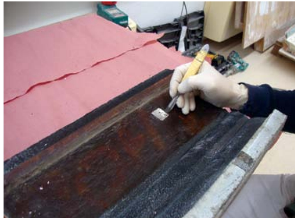
Vipolže, vila Vipolže, poskusno odstranjevanje barvnih plasti s preklade kamina v ateljeju Restavratorskega centra (foto: Š. Govže)
