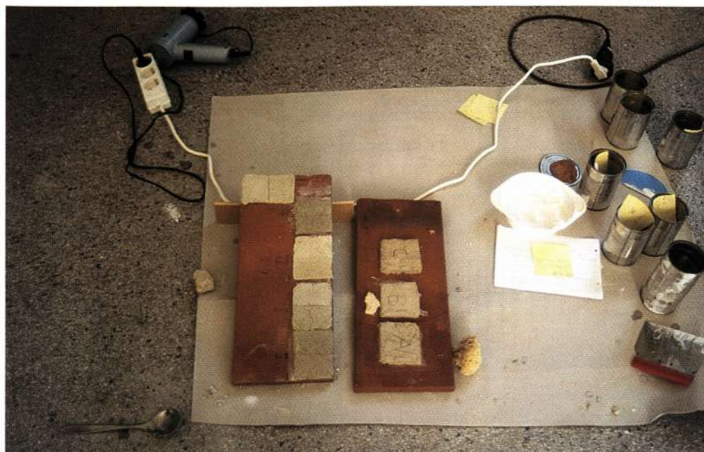
Injiciranje odstopljenih plasti originalnega ometa ter iskanje ustreznih odtenkov in sestave apnenih ometov za restavriranje fasade kartuzijanske knjižnice v Mauerbachu. (Vse fotografije: M. Kavčič)
