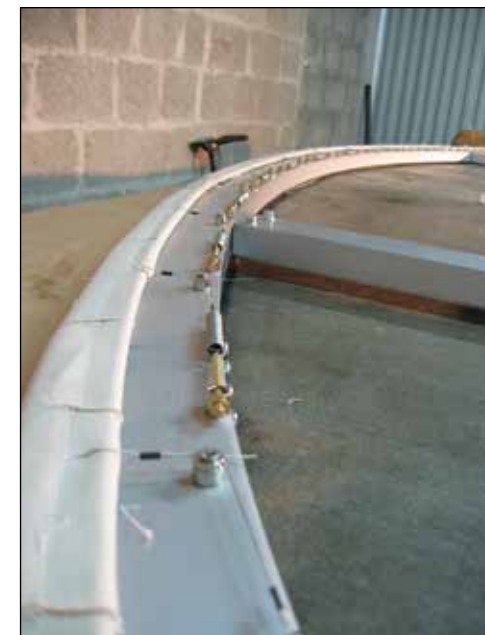
Slika 3: Detajl aluminijastega podokvira s prožnim mehanizmom iz Francije.
