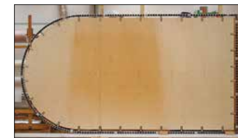
Slika 11: Aluminijasti podokvir v naravni velikosti od spredaj, pri čemer je vidna lesena plošča, ki ščiti hrbtno stran slike.
