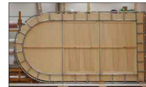
Slika 10: Aluminijasti podokvir v naravni velikosti od zadaj, pri čemer sta vidna glavna konstrukcijska elementa: zunanji in notranji okvir.
