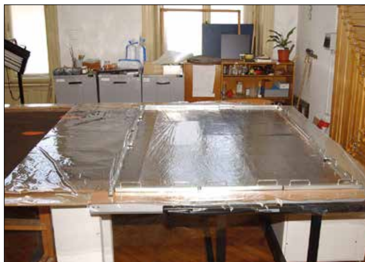
Slika 9: Toplotna obdelava slike v nizkotlačni mizi je omogočila aktiviranje termoplastičnega utrjevalca Plexisola P550-40 %.
