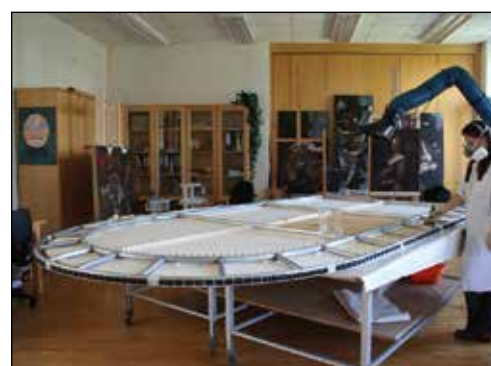
Slika 16: Premazovanje lesene površine z zadnje strani.
