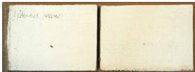
Slika 18: Preizkušanca, podlepljena z lanenim platnom in akrilno disperzijo 498 HV. Lepilo ni prodrlo na lice.
