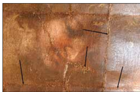
Slika 31: Podloga se je luščila in odpadla tudi ob šivu in na področjih zmečkanin.
