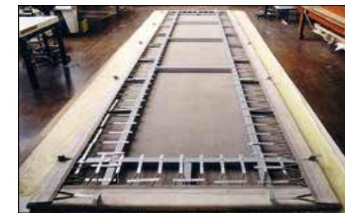
Slika 5: Velik pravokoten aluminijast podokvir s Hrvaške, izdelan za sliko Serafina Schöna iz frančiškanskega samostana v Trsatu (Hrvatski restavratorski zavod, Zagreb).
