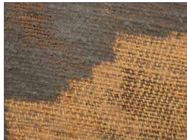
Slika 14: Premaz smo nadzorovano stanjšali. Ostanke so vidni v prostoru med votkovnimi in osnovnimi nitmi.
