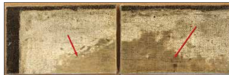
Slika 14: Prodiranje naravne smolno-voščene mase na lice preizkušancev.
