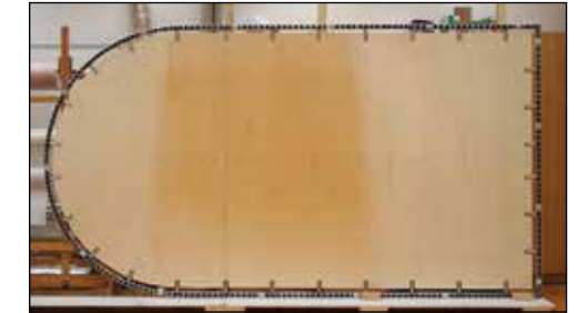
Fig. 11: Il fronte del telaio di alluminio a grandezza naturale dal fronte: è visibile il pannello di legno che protegge il retro del dipinto.
