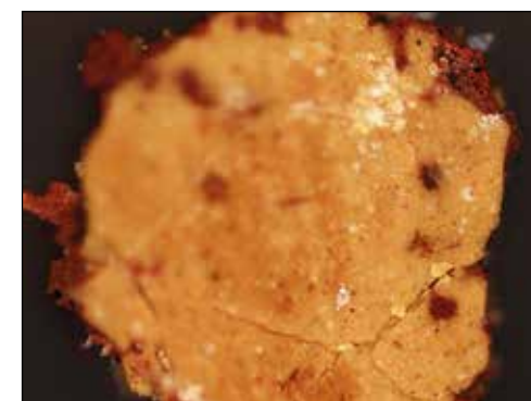
Fig. 64: LPM 39, superficie pulita con una soluzione acquosa al 10% di Vulpex, pH 8,5; VIS.
