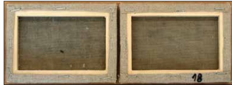
Fig. 17: Il verso dei simulanti foderati con il tessuto sintetico Lascaux P 110 e con l'adesivo Lascaux 443-95.
