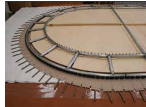
Fig. 13: Le viti sulla cornice interna sono fissate a distanza regolare.
