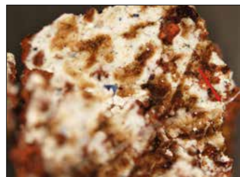
Fig. 40: LPM 29, superficie pulita con una soluzione acquosa al 10% di Vulpex, pH 10; VIS. Sulla superficie del campione è visibile una fibra, residuo della speciale carta utilizzata per consolidare gli strati pittorici.
