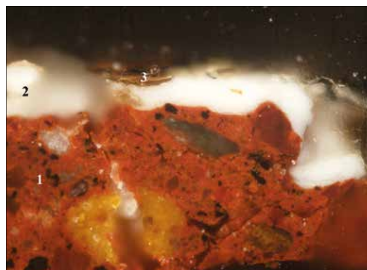
Fig. 22: LPM 22, stratigrafia della superficie non pulita, VIS. Con i numeri sono indicati gli strati: 1 – preparazione, 2 – colore bianco della veste, 3 – muffa.
