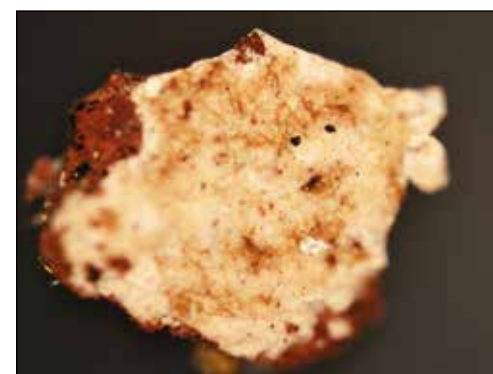
Fig. 74: LPM 32, superficie non pulita; VIS. Nello strato di vernice sono visibili i resti di microrganismi.
