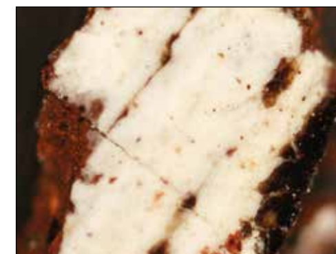
Fig. 30: LPM 21, superficie pulita con una soluzione di Vulpex al 10% in white spirit; VIS.
