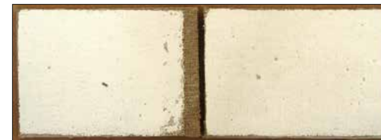
Fig. 20: Campioni di prova foderati con tessuto sintetico Lascaux P 110 e film di Beva 371. La colla non è penetrata sul recto.
