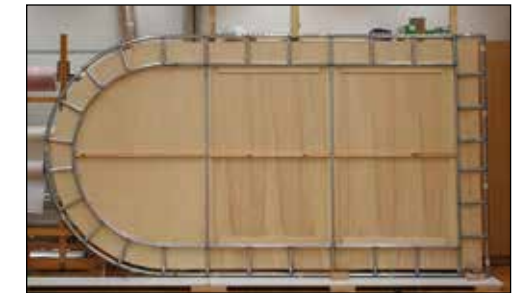
Fig. 10: Il retro del telaio di alluminio a grandezza naturale dove si vedono i principali elementi strutturali: la cornice esterna e quella interna.
