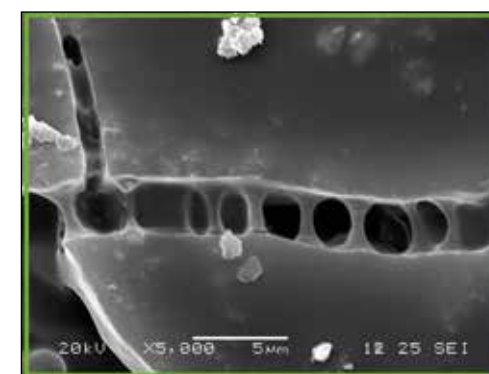
Fig. 78: LPM 32, superficie non pulita; SEM (x3044), campione con copertura in oro. Particolare di una fessura nella vernice.
