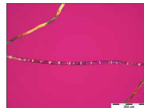
Fig. 10: Fotografia della fibra di lino alla luce polarizzata con compensatore lambda a 530 nm (colori magenta)
