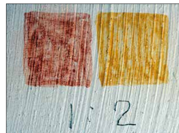
Slika 1: Testiranje veziva v praksi – apneni belež na kartonskem nosilcu (tudi sliki 3 in 4)
