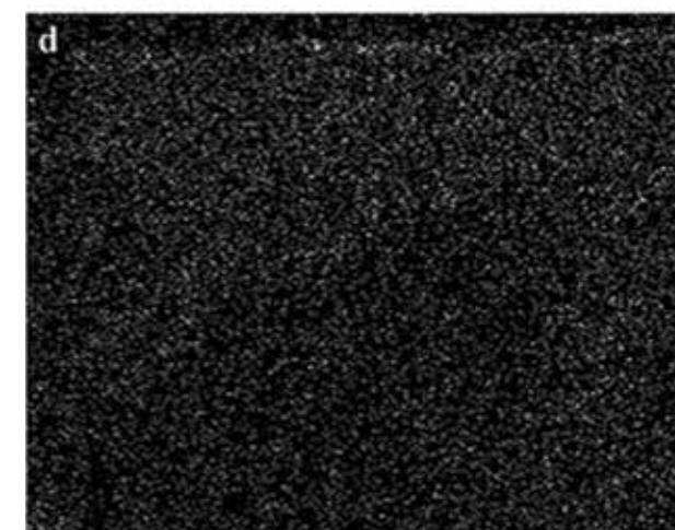
Slika 4: a) Presek vzorca št. 155a. b) EDS-razporeditev žvepla na preseku vzorca št. 155a ( w_s = 2,62\% ). c) Presek vzorca št. 153. d) EDS-razporeditev žvepla na preseku vzorca št. 153 ( w_s = 0,32\% ).
