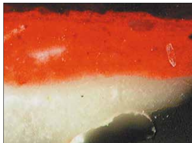
Slika 2: Presek vzorca št. 140 pod optičnim mikroskopom. Rdeča barvna plast na apneni podlogi. 400-kratna povečava.
