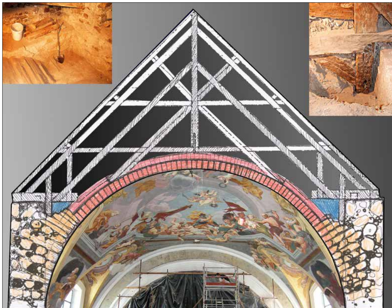
Slika 73: Prezre oboka in ostrešja: večina oboka je zidana iz opeke, le v predelu naslanjanja na steno ladje so v peto oboka pozidali kamnite plošče, ki smo jih odkrili po začasnem odstranitvi nasutja (slika levo zgoraj). Nasutje je na ilustraciji označeno modro. Lesena strešna konstrukcija razporeja glavino svoje teže na obe nosilni steni, na obok pritiska le tangencialno preko ločnih nosilcev in tako zmanjšuje razpiranje oboka. Na sliki zgoraj desno je del ostrešja, ki je sidran v predel nasutja in tako tvori neke vrste horizontalno vez. Zaradi dolgoletnih ponavljajočih se skrčkov in raztezkov vgrajenega materiala, pa tudi potresnih premikov, so se v vrhu oboka oblikovale globoke vzdolžne razpoke čez celotno dolžino ladje (slika 74).
