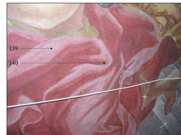
Fig. 1: Esempio dei punti di prelievo di due campioni (n. 139 e 140) dai drappaggi rossi.
