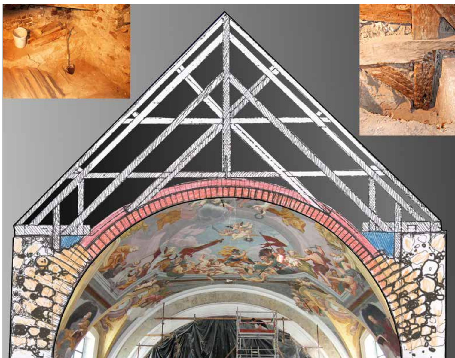
Fig. 73: Sezione della volta e dell'ossatura del tetto: gran parte della volta è realizzata in mattoni. Soltanto nella zona in cui si appoggia alla parete della navata, in prossimità del piede d'imposta, sono state murate delle lastre di pietra che abbiamo scoperto dopo aver temporaneamente asportato il materiale di riempimento (fig. in alto a sinistra). Nell'illustrazione il materiale di riempimento è colorato in azzurro. L'ossatura lignea del tetto distribuisce la gran parte del proprio peso su entrambi i muri portanti, premendo solo tangenzialmente sulla volta attraverso gli archi estradosali in laterizio ed in tal modo ne riduce i dissesti da spinta. Nella figura in alto a destra si vede una parte della struttura del tetto ancorata nella zona del riempimento che crea così una specie di tirante orizzontale. Al vertice della volta si sono formate delle profonde fessure con andamento longitudinale distribuite su tutta la lunghezza della navata e causate non solo dalle dilatazioni e dalle contrazioni del materiale usato per le murature, protrattesi negli anni, ma anche dagli spostamenti indotti dalle scosse sismiche (fig. 74).
