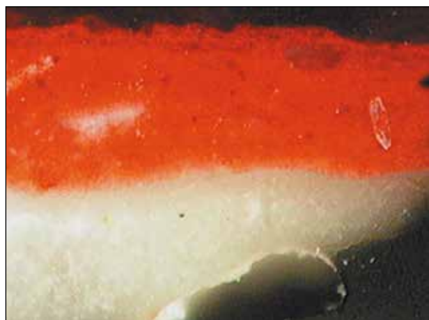
Fig. 2: Sezione del campione n. 140 al microscopio ottico. Strato di colore rosso su supporto di calce. Ingrandimento 400x.
