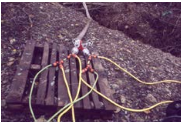
11 Razdelilna naprava (dvojak oziroma trojak) z gibljivimi cevmi.
