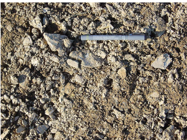
11 Tla v sondi 4. Tanek A horizont leži na slabo izraženem kambičnem (B) horizontu. Skupaj sta debela le 15–20 cm. Geološka podlaga tal je prodnato peščen mulj (C). Ta sediment interpretiram kot sediment nastal na aluvialni poplavni ravnini potoka Pržanec. Ta tla niso bila nikoli orana.
