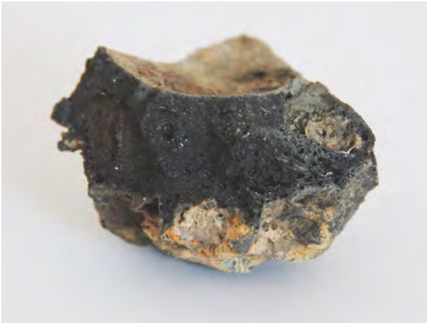
455 Prerez nemagnetnega kosa žindre VZ 59.
