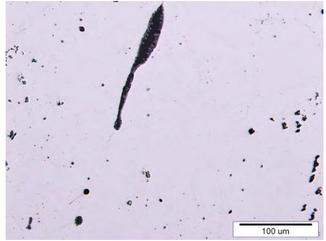
464 Mikroskopski posnetek razpotegnjene nekovinskega vključka v kovinskem vzorcu PN KOV 58, G1120.
