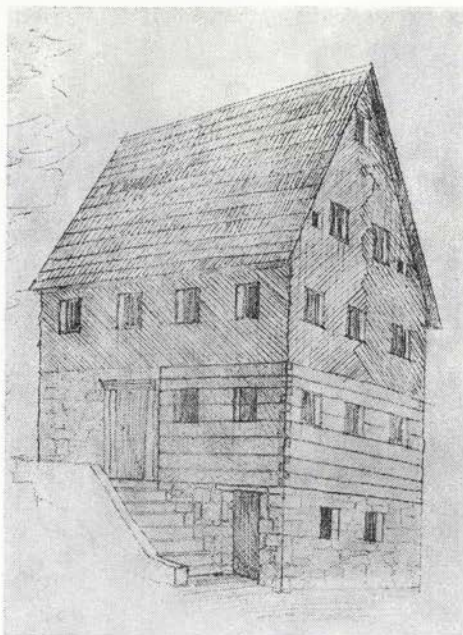
Sl. 57. Idrija, Bazoviška 4 — rudarska hiša, risarska dokumentacija lesene konstrukcije Fig. 57 — Idrija, Bazoviška St. 4, a miner's house, drawn documentation of the wooden construction
