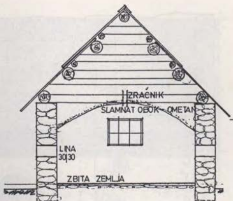
Sl. 154. Ukanc, planina Blatce. Prečni prerez stanu, l. 1982. (risba T. Markič)
