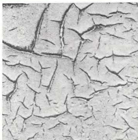
Sl. 48, 49. Pokanje predebelega namaza podloge in vpliv debeline in pigmentacije na obnašanje namaza
