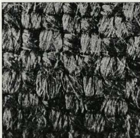
Sl. 54 Vzorec 241, primer neizrazite teksture, močno sploščeno platno
