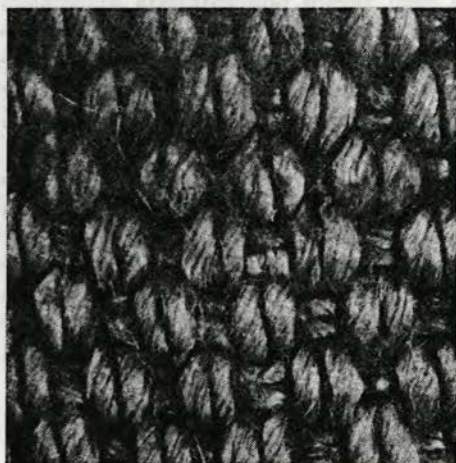
Sl. 52 Vzorec 202, panama vezava z izrazito zrnatostjo
