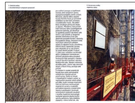
Primer utrjevanja ometa z apneno vodo na fasadi gradu v Češkem Krumlovu (iz brošure Obnova a konzervace zapadního průčelí Horní hrad, Češki Krumlov )
