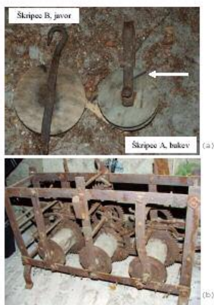
Slika 2. Stolpna ura v p.c. Sv. Križ, Dednja vas pri Pišecah. (a) Škripca iz lesa javorja (levo) in bukve (desno). Puščica kaže mesto merjenja širin branik. (b) Trije leseni valji. Les ni bil dostopen za merjenje širin branik.
